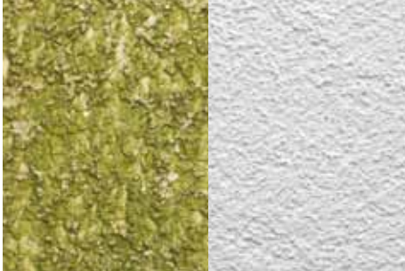
WDVS-Dämmstoff ohne und mit Wärmespeichervermögen: Die speicherfähige Holzfaserdämmplatte reduziert das Risiko des Algenbewuchses.
